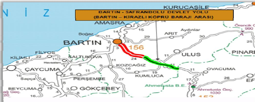
Toplam uzunluğu 77 km olan mevcut yolun (35 km'si Bartın, 42 km'si Karabük ilimizdedir.) Bartın çıkışında 2 km BSK BY, Kirazlı köprüye kadar SK BY (Karabük-Kastamonu) Ayr-Eflani Ayr. Arası SK BY olmak üzere toplam 29,5 km'si BY yapılmıştır. Eflani Ayr.-Kirazlı köprü arasındaki kalan kesim için kılavuz plan hazırlanmıştır. Kılavuz plana göre TY projesi yapılacaktır. Projede toplam 6719 m uzunlığında 4 tek tüp tünel yapımı öngörmektedir ve yol 8,3 km kısaltmaktadır.
