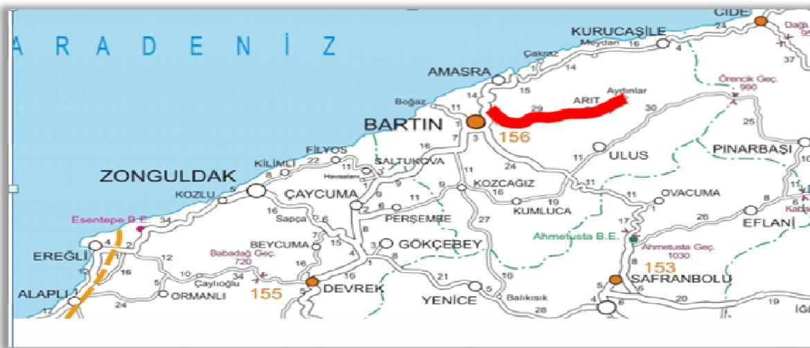
Toplam 36 km uzunlığında 2A standardındaki yolun 10,5 km'si sathi kaplamalı TY olarak bitirilmiştir. Çome boğazında 3 km'lik kesimde çalışmalar devam etmektedir.
